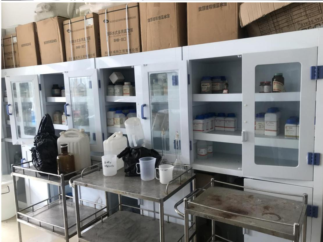
4、C119 无机化学实验室由于准备室试剂柜未安装通风装置，开柜门通风方法不妥当，整改意见：申报安装试剂柜抽风机。另学期末用完的易制毒试剂仍放置在通风橱。**整改意见：清理分类后即刻转移至危化品仓库。**
